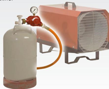
Haupt Einsatzgebiet des Sicherheitssystem bestehend aus der Sicherheitseinrichtung GASSTOP, Doppelschlauch und Verbindungsrippel, ist das Absichern von Flüssiggas-Verbrauchsgeräten, die unter Erdgleiche oder im Dauerbetrieb im Einsatz sind. Durch das Doppelschlauchsystem wird auch bei diesen Einsatzfällen durch unkontrollierten Gasaustritt (auch Kleinstleckagen) die Ansammlung von explosiven Gas-Luft-Gemischen auch im Dauereinsatz verhindert.
