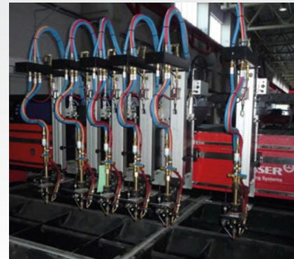
Brennschneidmaschine mit DG91UA und GG. Durch die kompakte (Modell GG) bzw. exzentrische Bauweise (Modell DG91UA) ist eine Installation auf engstem Raum leicht durchführbar. Die Sicherheitseinrichtungen eignen sich zum
