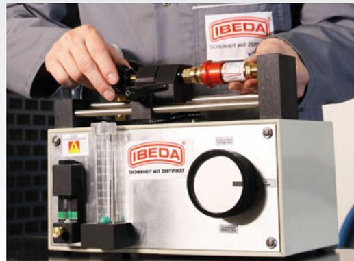
Die Vorbereitungen für die jährlichen Prüfungen vor Ort sind problemlos durchzuführen. Eine waagerechte Oberfläche von 50 x 50 cm, ein ölfreier Druckluftanschluss oder Stickstoff (z.B. Flasche) und etwas destilliertes Wasser (5 cl) reichen zum Einrichten des Prüfgerätes. Das Gerät wird mit allen notwendigen Anschlussadaptern, die leicht auswechselbar sind, geliefert. Nachdem das Gerät justiert wurde, kann mit den Prüfungen begonnen werden.
