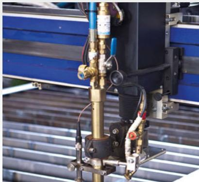
Brennschneidmaschine mit **DG91UA** und **GG**
