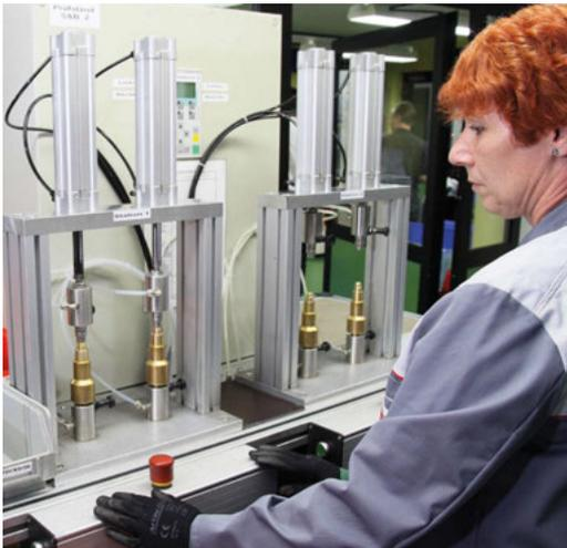
**PRÜFAUTOMATEN FÜR GASRÜCKTRITT-, DICHTHEITS- UND FLAMMENRÜCKSCHLAG-PRÜFUNG**
