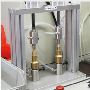
Prüfung der Sicherheitseinrichtung mit druckgesteuerter Nachströmperre DS2000 auf Gasrücktritt, Dichtheit und Funktion der Nachströmperre.
